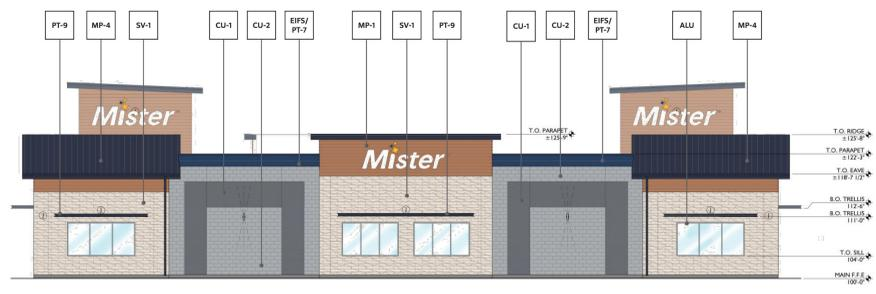
2 CAR WASH TUNNEL WALL ELEVATION
