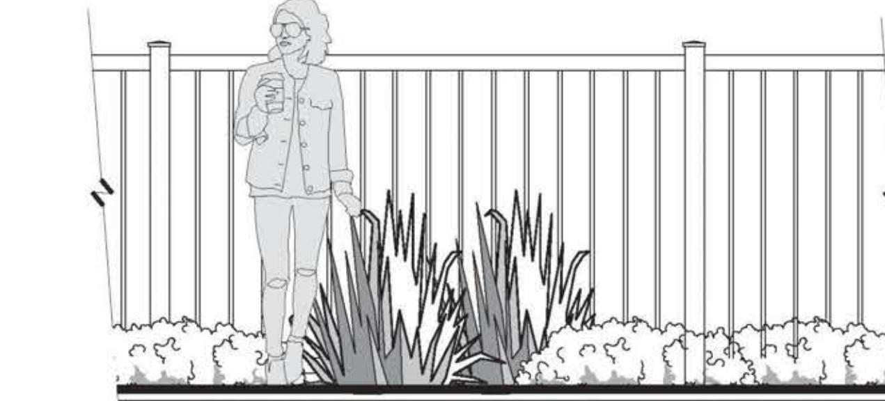
C 5' HT. TUBE STEEL POOL ENCLOSURE
